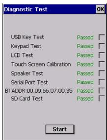
Zum Ende der Tests erscheint wieder das erste Dialogfeld und zeigt an, welche Tests erfolgreich waren und welche fehlschlugen. Beachten Sie, dass die Bluetooth-Verbindung durch eine interne Routine getestet wird (siehe Zeile BT ADDR:... ).
