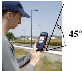
In dieser Position funktioniert die Antenne am besten und ermöglicht die höchste Genauigkeit.
