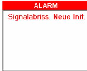
In diesem Fall müssen Sie leider die gesamte Vermessung oder einen Teil davon wiederholen. Aufgrund der Unterbrechung des Datenflusses der erfassten Daten kann die Auswertesoftware nicht die Genauigkeit für alle Punkte, die Sie NACH der Datenunterbrechung vermessen würden, erreichen.
