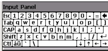
Die Bildschirmtastatur besitzt Sondertasten wie Umschalt- und Feststelltaste zur Umschaltung zwischen Groß- und Kleinschreibung, eine Rücktaste zum Löschen des zuletzt eingegebenen Zeichens, eine Leertaste usw.
