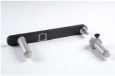
Den Initialisierungsstab können Sie nutzen, um Ihre Messungen von einem Basispunkt zu initialisieren. Dieser 20 cm lange Stab sollte im Voraus auf dem Dreifuß der Basis montiert werden. Der Antennenadapter wird am freien Ende des Initialisierungsstabs eingesetzt und nimmt provisorisch die Antenne der Mobilstation auf, solange die Initialisierung läuft.
