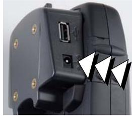
Stecken Sie den Netzstecker in diese Buchse.
