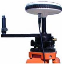
*Vorbereiten der kinematischen Initialisierung an der Basis mit dem Initialisierungsstab*
