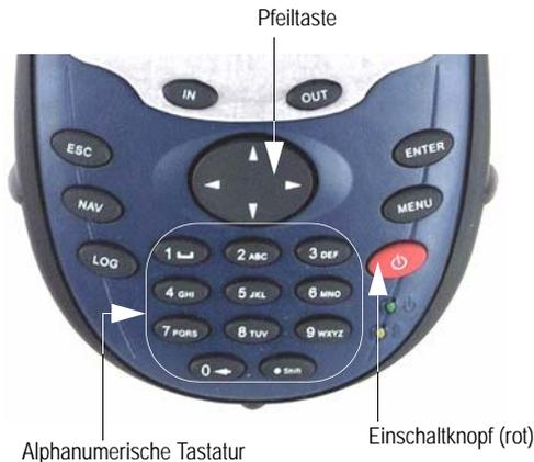
Unterhalb des Displays sehen Sie 8 Tasten, die um die große ovale Pfeiltaste mit 4 Richtungsfeilen angeordnet sind.
